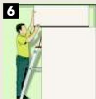
Colocar a bandeira juntamente com a travessa, fechando o módulo de painel cego.
