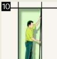
Colocar os batentes encaixando-os dentro dos montantes; colocar primeiro o batente superior (horizontal) e depois os inferiores (verticais).
